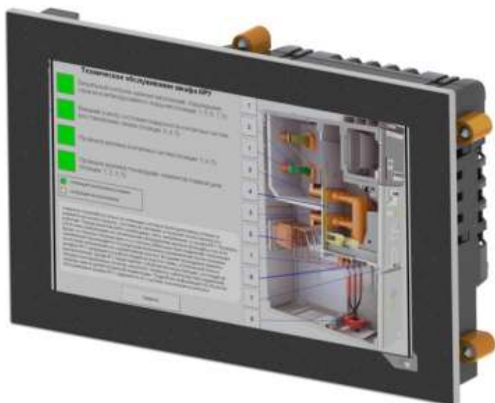
Рис.4 Система мониторинга, управления и диагностики оборудования «КРУ Smart View».
