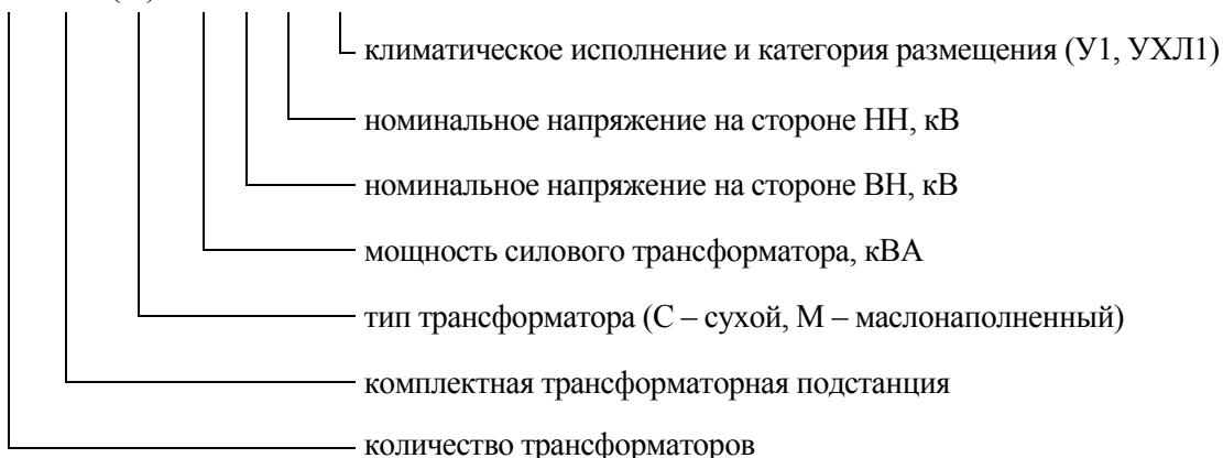
Пример записи условного обозначения КТП: КТП(М)-630-10/0,4-УХЛ1 – комплектная трансформаторная подстанция с одним масляным трансформатором мощностью 630 кВА, на номинальное напряжение 10/0,4 кВ, климатического исполнения УХЛ1.
