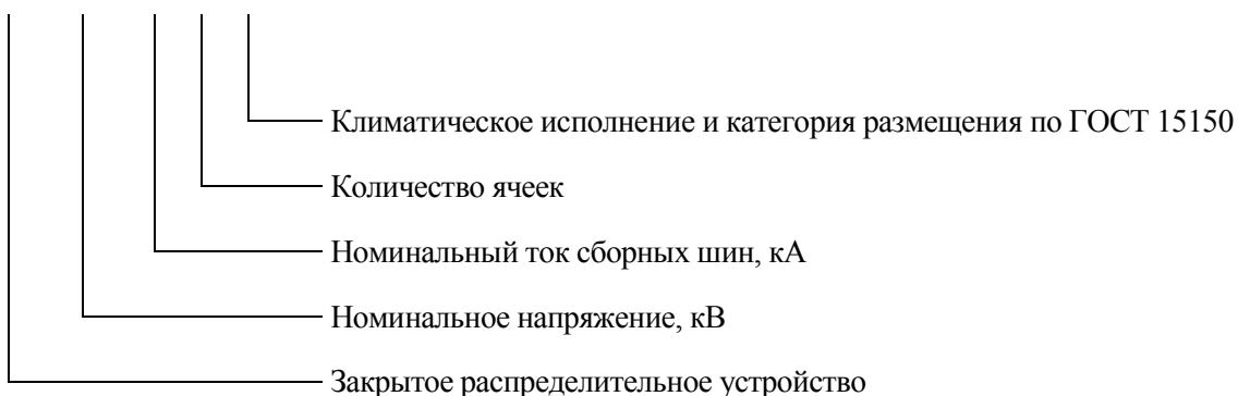
Пример записи условного обозначения ЗРУ-10-3150-8-УХЛ1 – закрытое распределительное устройство на номинальное напряжение 10 кВ, номинальный ток сборных шин 3150 А, с 8 ячейками, климатического исполнения УХЛ1.
