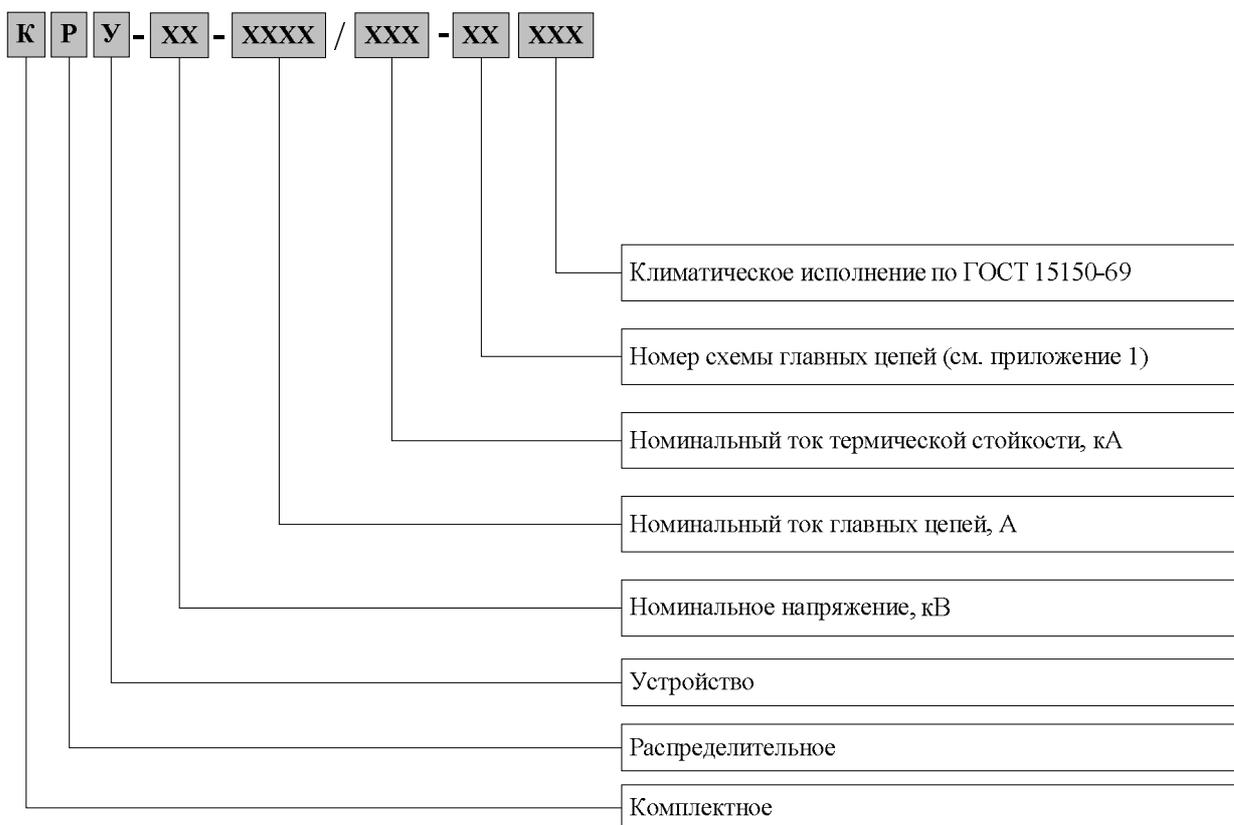
Пример записи условного обозначения: КРУ-10-2500/31,5-1 УЗ.1 – комплектное распределительное устройство на номинальное напряжение 10 кВ, номинальный ток 2500 А, ток термической стойкости 31,5 кА со схемой главных цепей № 1 климатического исполнения УЗ.1.
