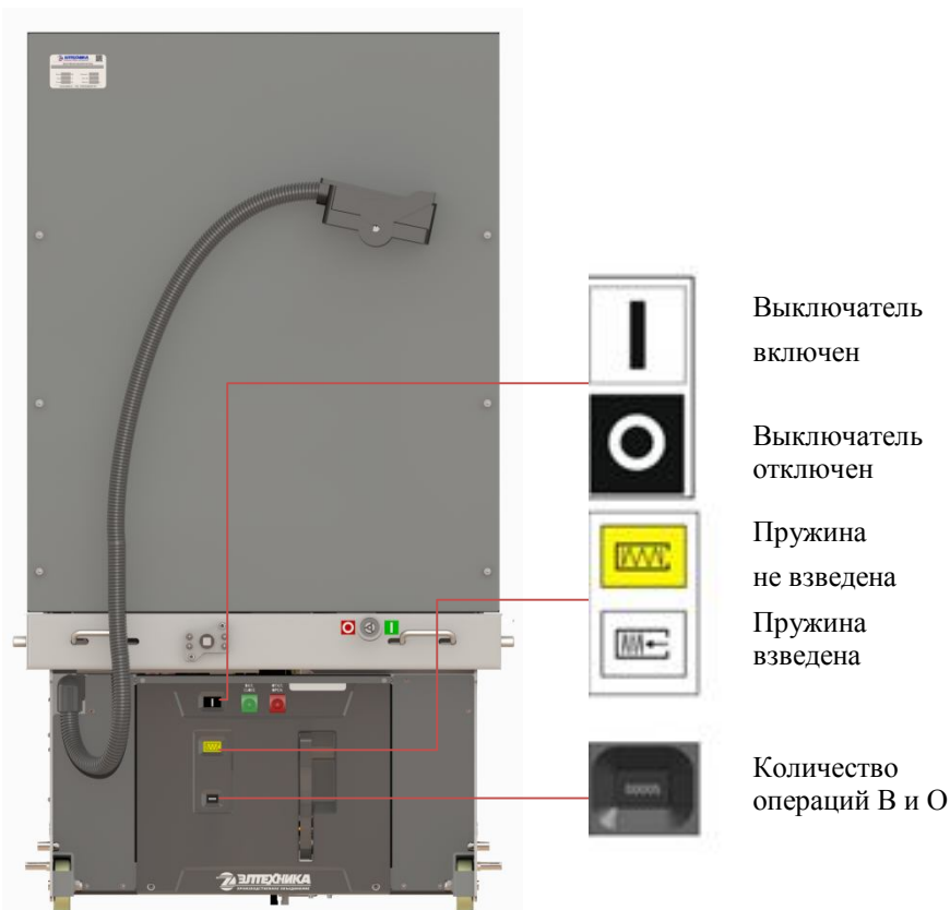
Рис. 4 Индикаторы на лицевой панели выключателя
