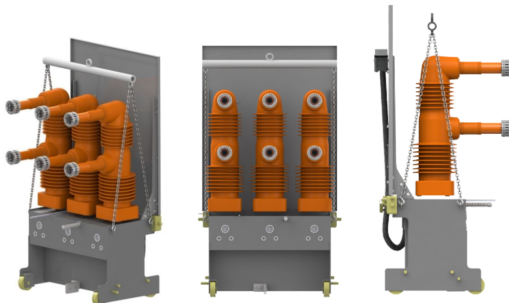
Рис. 19 Расположение приспособлений для подъема выключателя
