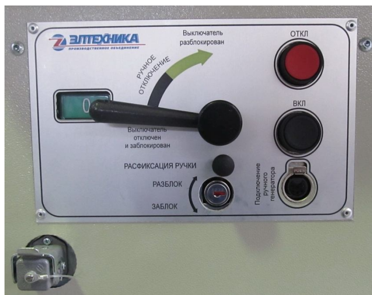
Рис.6в Рукоятка отключения заблокирована.
