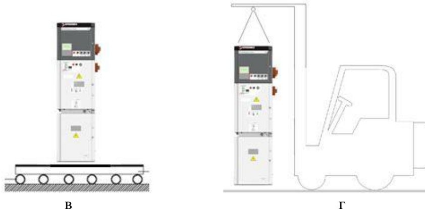
Рис. 16. Способы перемещения шкафов КРУ на транспортном поддоне
